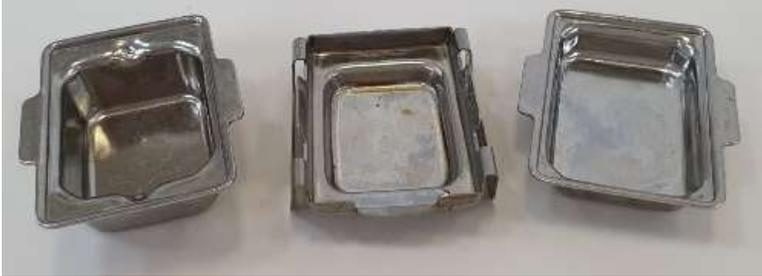
Os moldes para colocação das amostras são fabricados em aço inoxidável e estão disponíveis em diversas dimensões e formatos.
