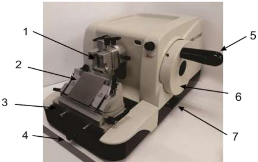
Nesse tipo de micrótomo, a navalha permanece fixa no porta-navalhas. Com o auxílio do sistema de rotação, acionado com a roda de mão, o bloco, fixado no prendedor universal de cassete, se move
