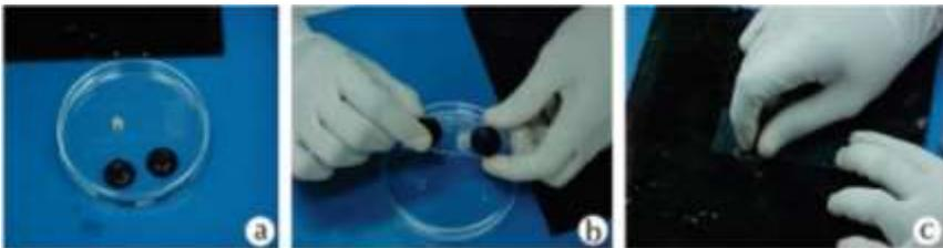
Conforme a lâmina com a amostra desliza sobre a lixa, o fragmento é desgastado. A observação ao microscópio durante o des-
